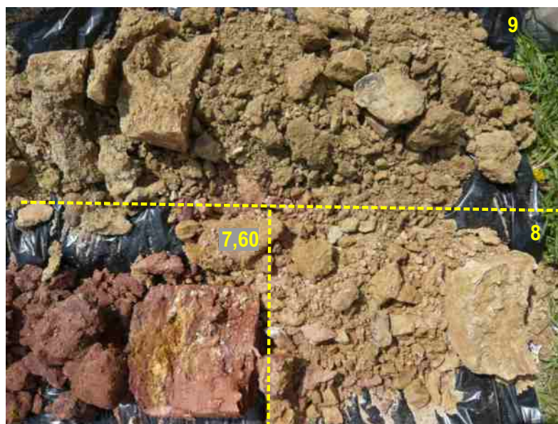
Foto č. 2. Detail fosilně zvětralých břidlic ve vrtu J 2
